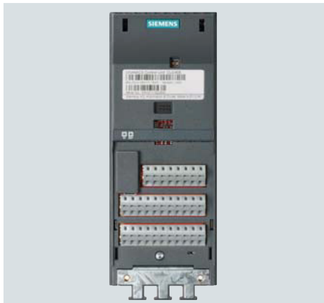
Control Unit CU240E sin tapa cubrebornes
